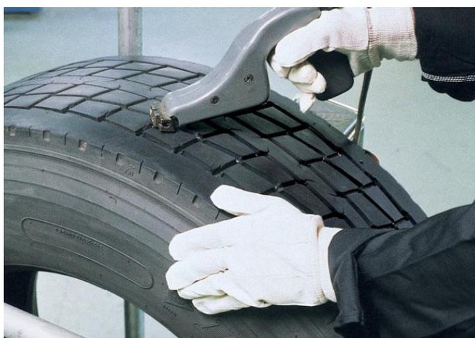
Lors du retailage, on creuse plus profondément la gomme de fond des rainures principales du profil du pneu en la taillant avec des équipements spéciaux. La condition est que la couche de gomme présente une épaisseur suffisante, afin qu'il reste au moins 2 mm d'épaisseur au-dessus de la couche supérieure de la ceinture.
